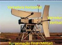
Radar 3D (azimute, distância e elevação) para aproximações de precisão.
