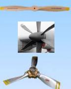
Três tipos de hélices: Hélice de passo fixo, Hélice de passo variável e Hélice de passo ajustável.
