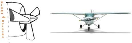
Diagrama de uma hélice com o ângulo de ataque zero grau, mostrando a corda e o plano de referência. À direita, uma fotografia de uma hélice montada em um avião.
