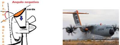
Diagrama de uma hélice com ângulo de ataque negativo, mostrando a corda e o plano de referência. À direita, uma fotografia de uma hélice montada em um avião.
