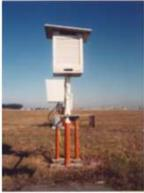
SENSOR DE TEMPERATURA DO AR (ABRIGO) E AMBIENTAL DA PISTA (ABAIXO DE PLACA METÁLICA)
