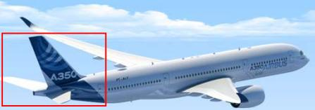
O estabilizador horizontal encontra-se abaixo do estabilizador vertical.
